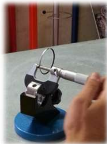
Mesure de l'épaisseur du segment
