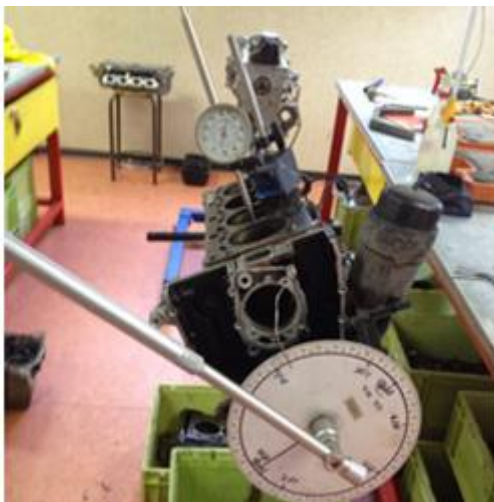
Mesure de la course du piston sur un moteur BMW 316i
