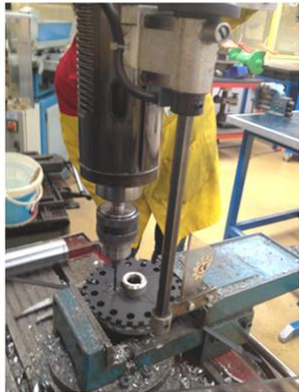
Percage des trous de fixation pour l'adaptation de la piste 58 dents sur le volant moteur du 650 SV
