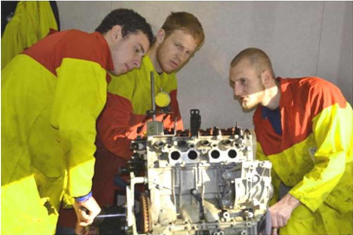
Fixation du support moteur de 650SV sur la plaque du banc d'essai
