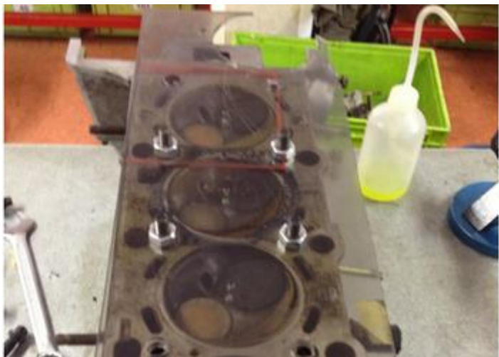
Mesure du volume de la chambre de combustion sur la culasse de BMW 316i
