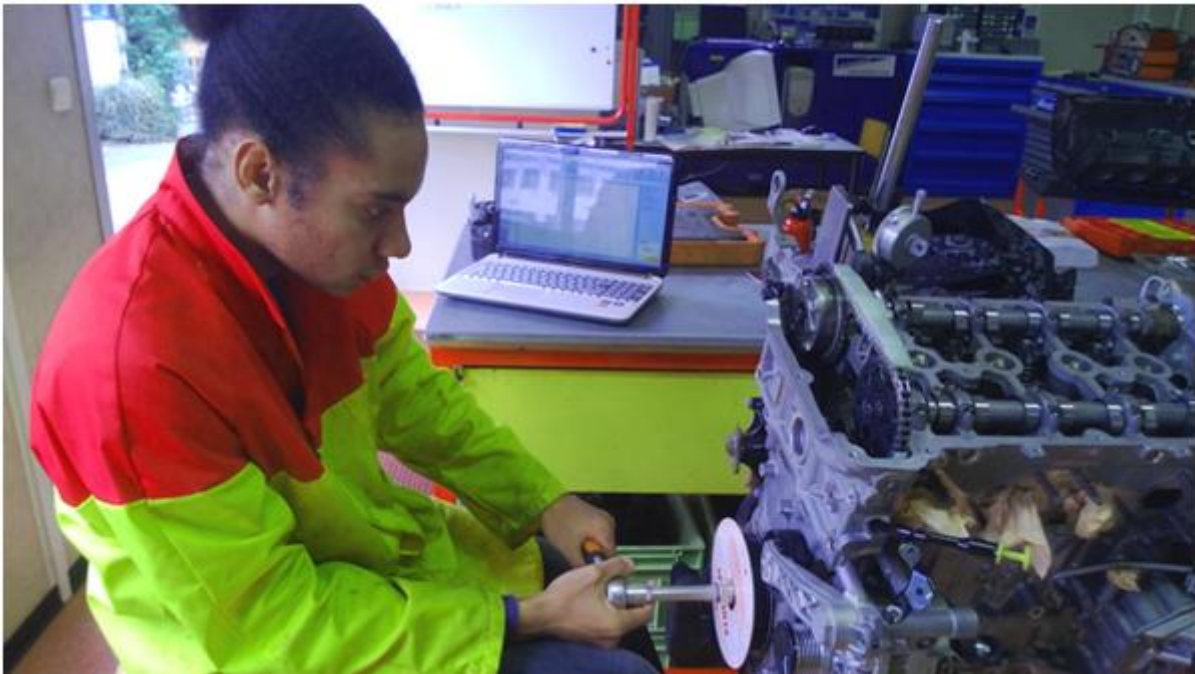
Contrôle du calage de la distribution
